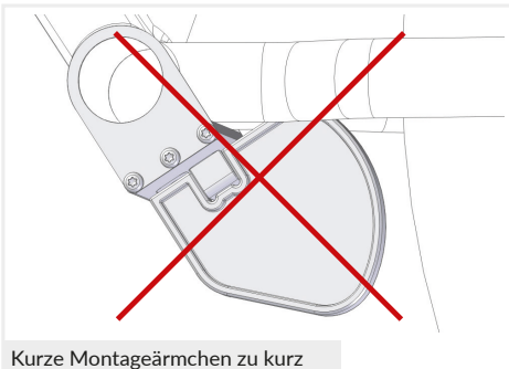
Kurze Montageärmchen zu kurz
