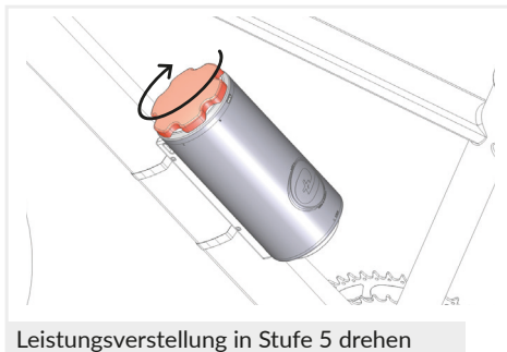
Leistungsverstellung in Stufe 5 drehen
