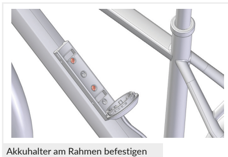
Akkualter am Rahmen befestigen
