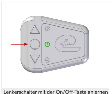
Lenkerschalter mit der On/Off-Taste anlernen
