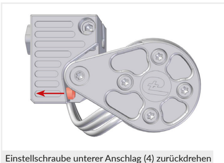
Einstellschraube unterer Anschlag (4) zurückdrehen
