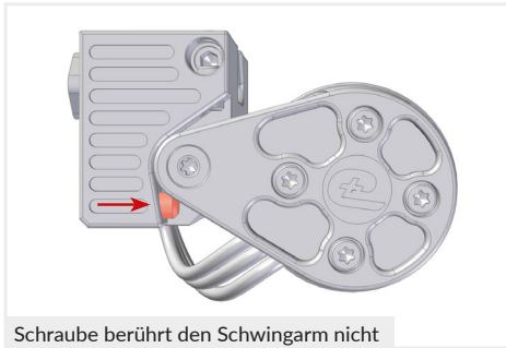
Schraube berührt den Schwingarm nicht
